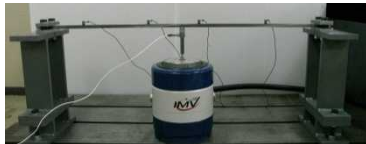
右図: 実験装置 (両端固定一様はり)
