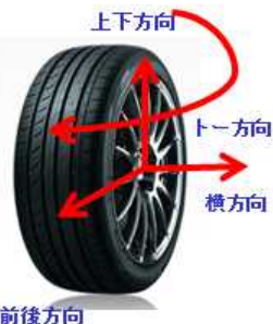
タイヤ-車軸間の力の伝達方向 ※タイヤ図は東洋ゴム工業(株)HPより参照
